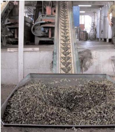
Die Oliven werden in die Mühle angeliefert und mit dem Förderband in die Anlage gebracht .....
