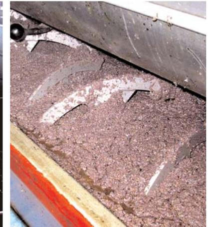
Dieser Olivenbrei aus Fruchtfleisch und Kernen wird dann mit einer Spindel weiterbefördert .....
