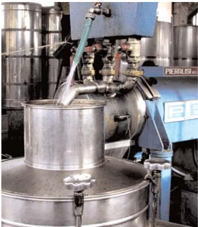
... und in die Zentrifuge geleitet, wo er mit ca. 30 - 40 Grad warmem Wasser versetzt .....
